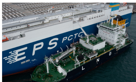
Utilizing STS for LNG bunkering
