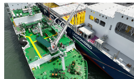
LNG bunkering simultaneous operation
